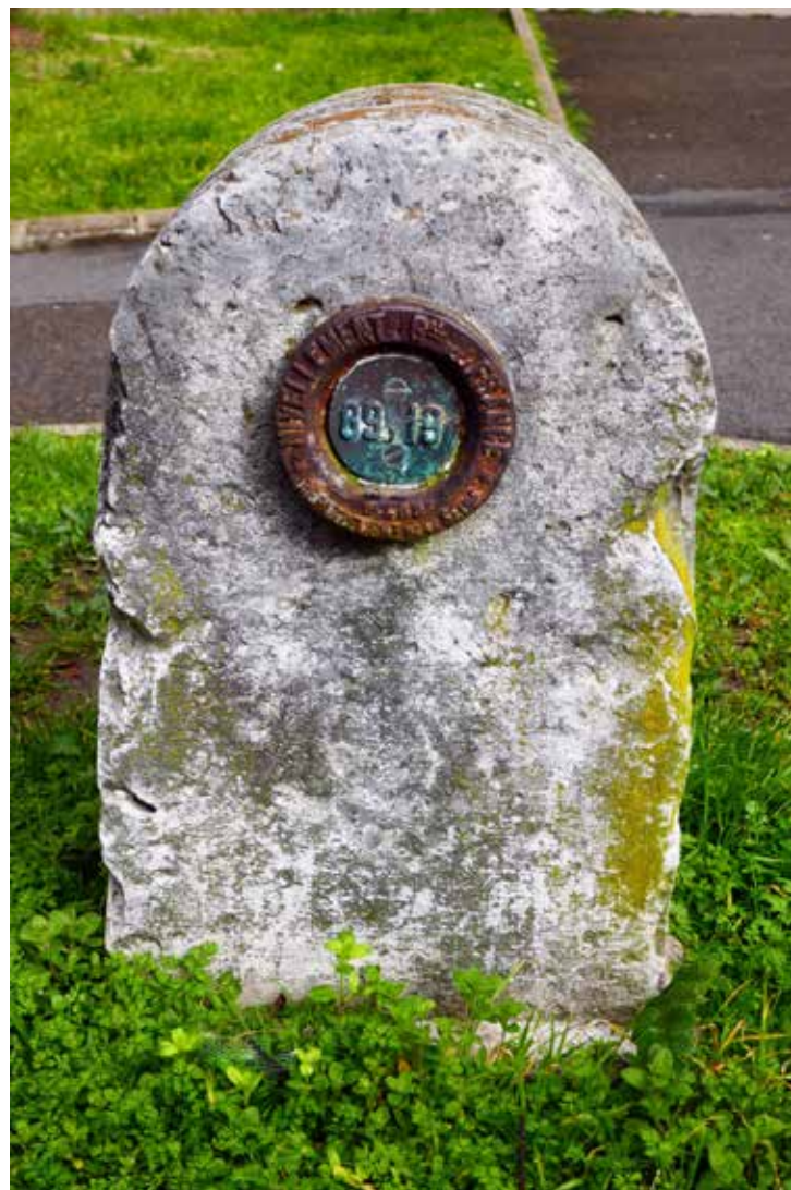
Borne du nivellement général de France, côté gauche montant de la rue de Neuilly (D244).
