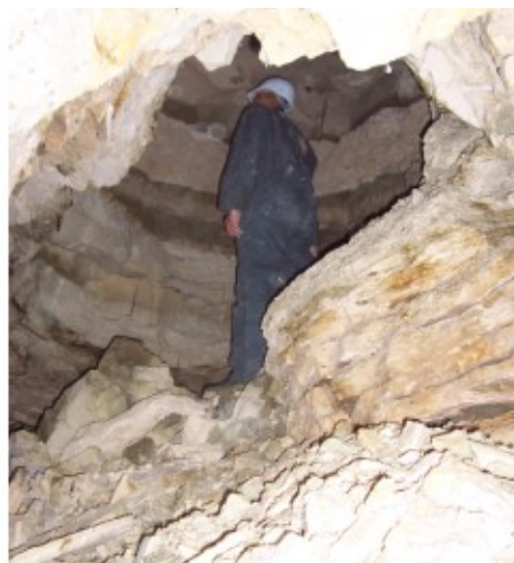
Figure 11. Cloche de fontis vue depuis une carrière de Gypse, à Luzancy (77) [Source : LREP, 2005]
